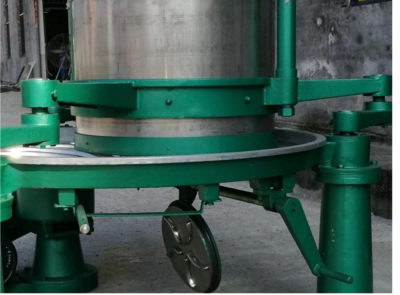
Makinenin destekleyici kısmı, güçlü ve dayanıklı olan dökme demirden yapılmıştır.
